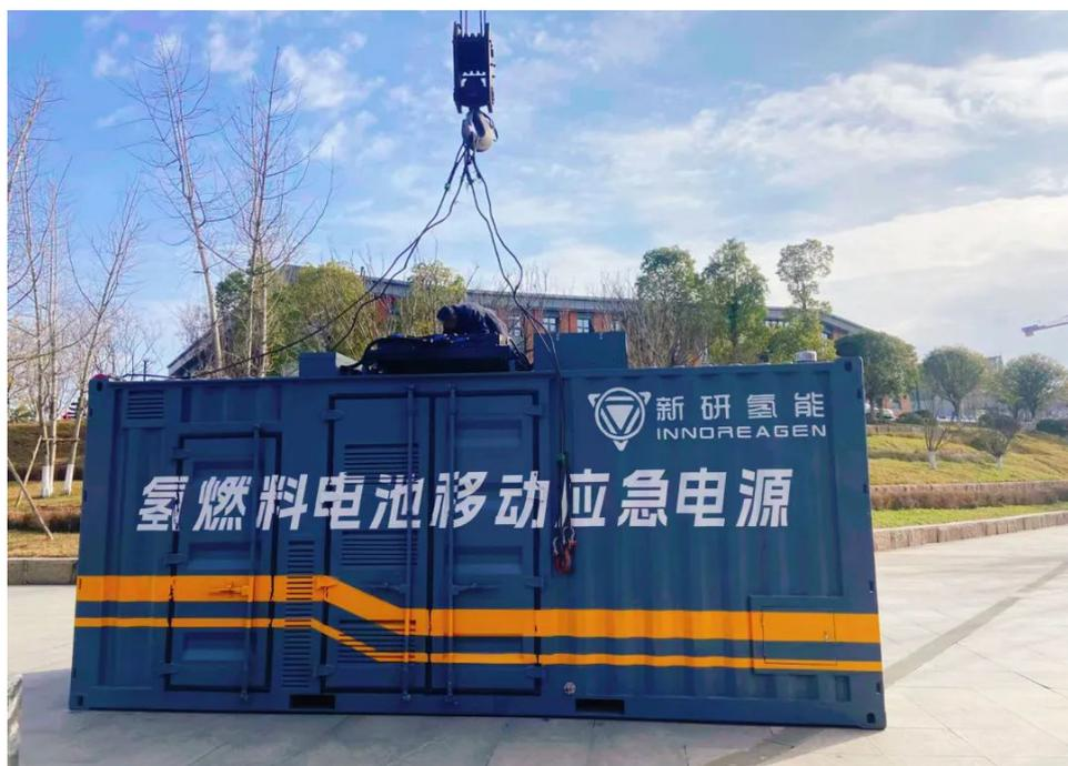
**点评** 相比于同类的应急电源，如锂电池应急电源充电时间较长，使用次数寿命较短，在低温和高温环境中存在启动慢、具有爆炸风险等问题，氢燃料电池应急电源可将燃料电池发动机产生的热能以及水进行收集再利用，实现恶劣条件下电力、热力以及饮用水全链条无污染的供应。氢燃料电池技术在交通、电力等行业已处于工业示范或商业应用阶段，整体接近国际先进水平，目前我国氢燃料
